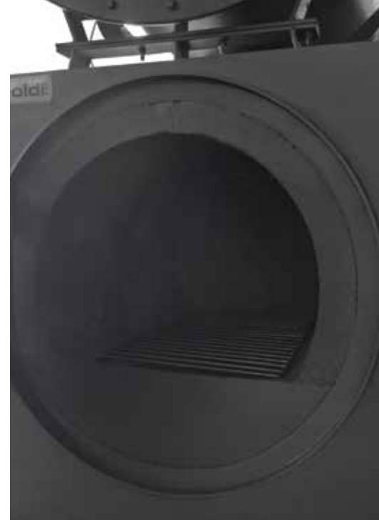
Sistema di abbattimento fumi tipo scrubber
